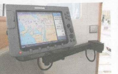
**SVINGER:** En av de to navigasjons-skermene er montert på svingarm slik at man kan følge med på skermen fra styrepllassen.
