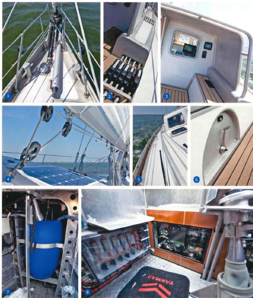
Details an Deck: 1.: Bugbeschlag mit Ankergalgen und Gennakerbaum-Führung sowie Festmacherpoller; 2.: Leinenumlenkung auf die Cockpitsüß; 3.: nach achtern verlängertes Kajütdach mit Haltegriffen; 4.: Großschotführung in Anlehnung an ein „German Cupper Mainsheet System“ (der Block im Vordergrund verkantet allerdings gelegentlich in Manövern); 5.: breite Laufdecks mit Fußbreitling; 6.: versenkter Maschinentelegraf; 7.: Kettenfass in der Vorpiek; 8.: Backskiste mit Technikraum.
