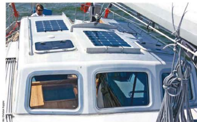
Das Deckshaus dient funktional als Erweiterung des Cockpits und bietet der Crew bei Kälte und Nässe einen Zufluchtsort mit uneingeschränktem Rundumblick.
