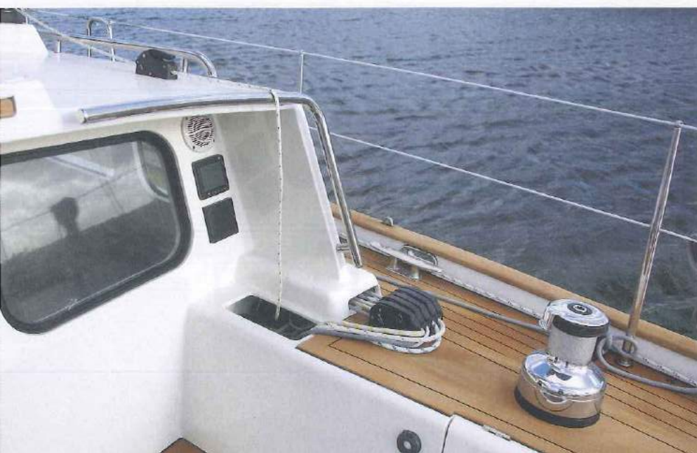
Geordnet. Fallen, Schoten und Strecker laufen direkt auf die großen Winschen
