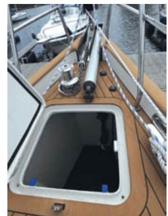
FORUT: Baugspryd, ankerspill og et stort stuerom på fremre del av dekket.
