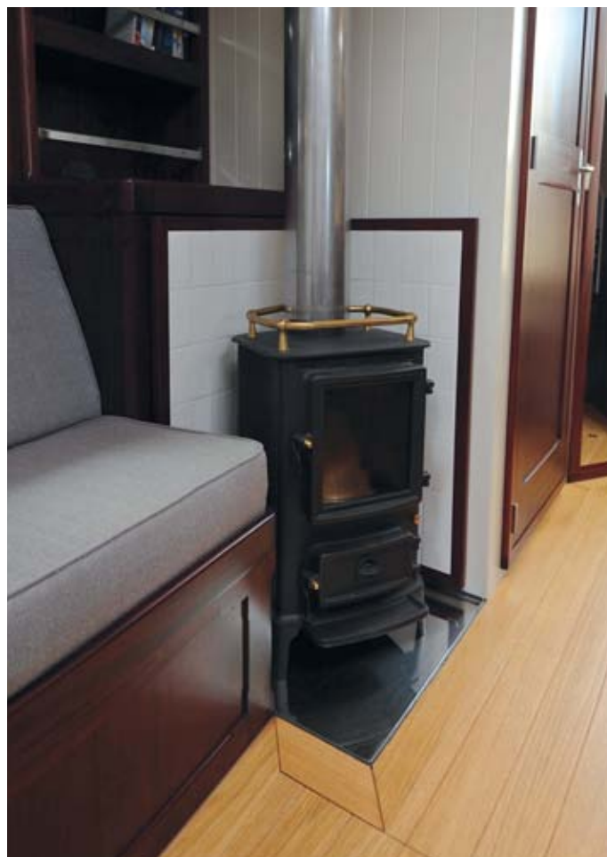
OVN: I prøvebåten var det installert en dieselfyrt Dickinson-ovn, som gir både kos og lunk i salongen.
