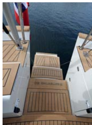
AKTER: Deler av akterspeilet kan felles ned og bli til en leder til sjøen.
