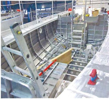
1) Über Kopf geschweißte Rumpfschale und Rumpf nach dem Drehen mit wasserdichtem Schott achtern.
