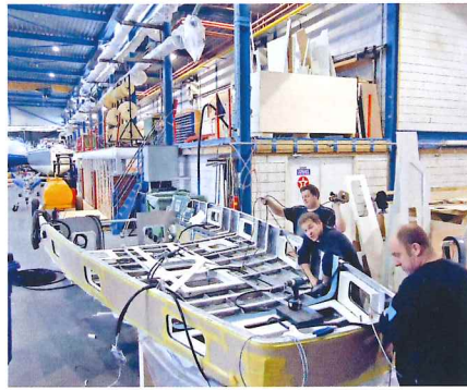
11) Aufbau wird für den Einbau vorbereitet.
