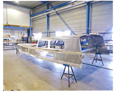
9) Aufbau im Rohzustand.
