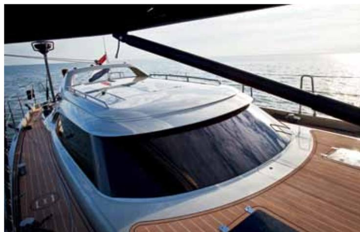
Above: a view of the deck built in the composite material Esthec, a substitute for teak. Top: the profile of the yacht and the interior layout. / Sopra, una vista della coperta realizzata con Esthec, il materiale dalle alte qualità che sostituisce il teak. In alto, il profilo dello scafo e il layout degli interni.
